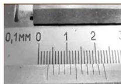
9-суре. Штангенциркуль немесе микрометр саңылаулары арқылы дифракцияны бақылау
