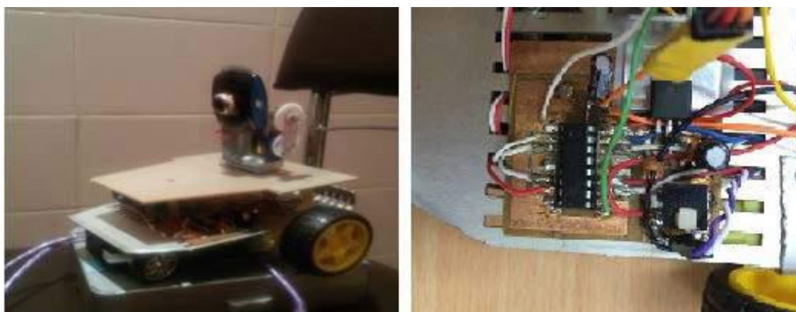
Рисунок 3. Внешний вид разработанного робота (а), и схемы питания и управления двигателями (б).
